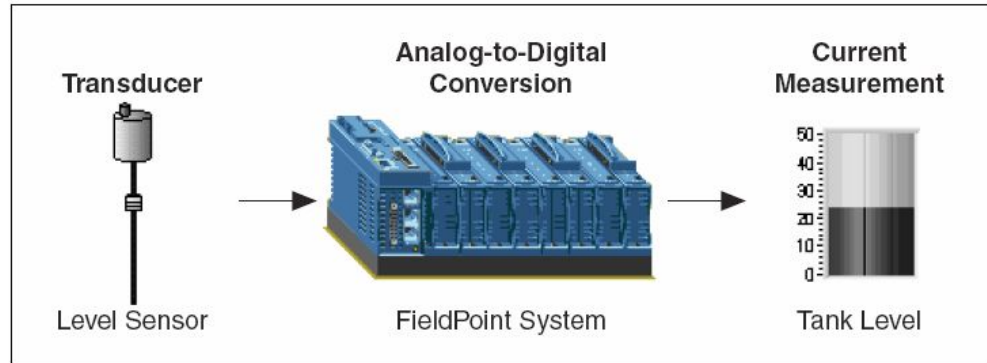
Рис. 9-6. FieldPoint система для измерения тока Transducer (Level Sensor) – преобразователь (датчик уровня); Analog-to-Digital Conversion (FieldPoint System) – аналого-цифровое преобразование (система на основе модулей FieldPoint); Current Measurement (Tank Level) – измерение тока (уровень жидкости в резервуаре)
