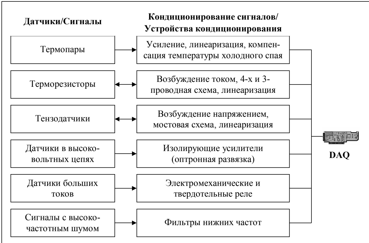
Рис. 4.3. Типы датчиков, сигналов и виды кондиционирования сигналов
