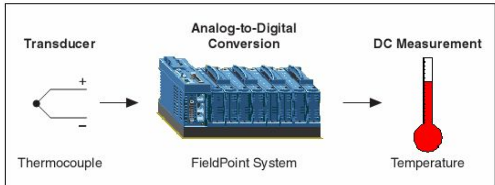
Рис. 8-4. Система на основе модулей FieldPoint для измерения температуры
