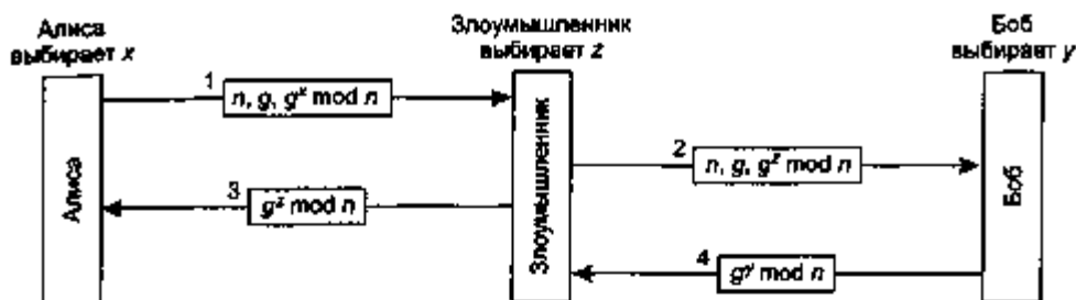
Рис. 8.34. Атака типа «пожарная цепочка»
