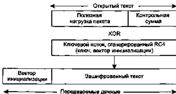
Рис. 8.27. Шифрация пакета с использованием WEP
