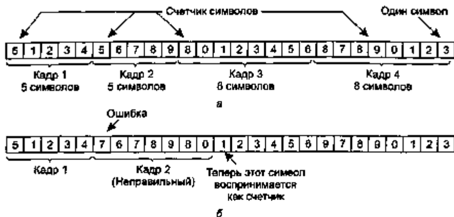
Рис. 3.4. Поток символов: без ошибок (а); с одной ошибкой (б)
