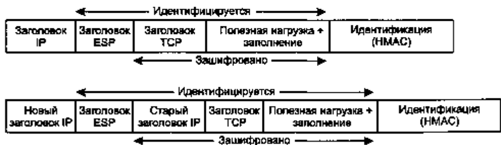
Рис. 8.24. ESP в транспортном режиме (а); ESP в режиме туннелирования (б)
