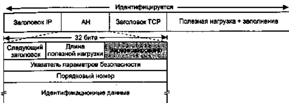
Рис. 8.23. Заголовок идентификации IPsec в транспортном режиме для IPv4
