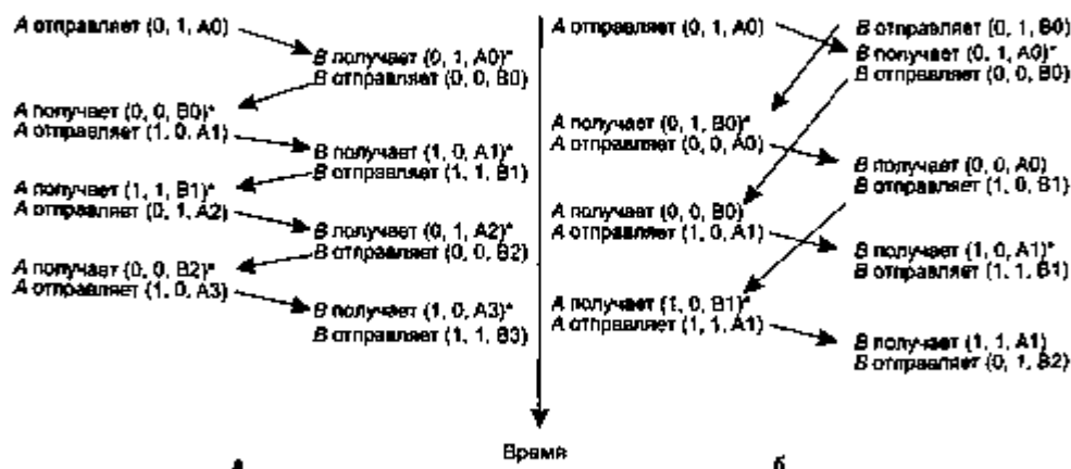
Рис. 3.10. Два сценария для протокола 4: нормальная ситуация (а); нештатная ситуация (б). Обозначения: (seq, ack, номер пакета). Звездочка означает, что сетевой уровень принял пакет
