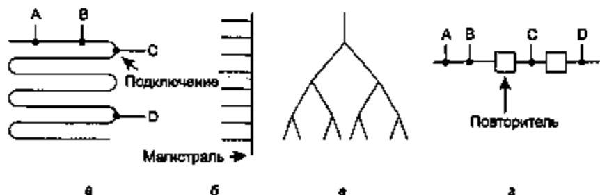
Рис. 4.14. Кабельная топология: линейная (а); магистраль (б); дерево (в); сегментированная (г)
