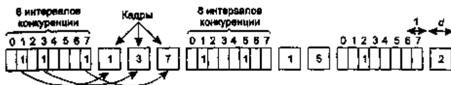
Рис. 4.6. Базовый протокол битовой карты
