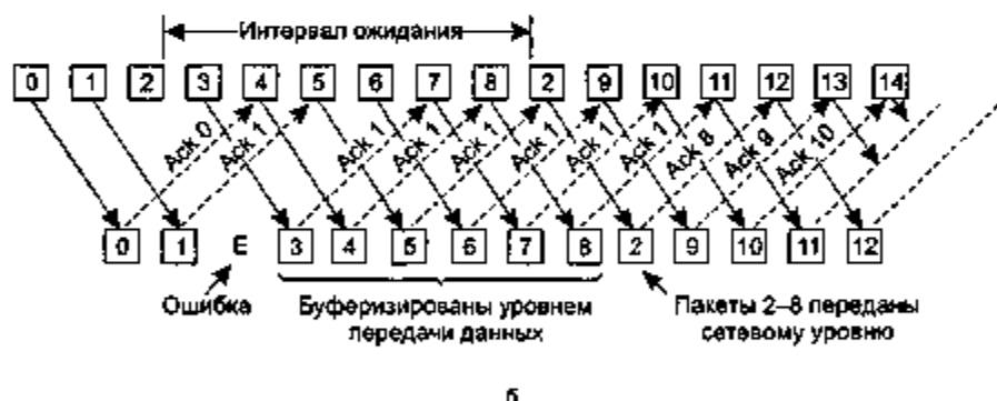
Рис. 3.11. Конвейеризация и коррекция ошибок: эффект при размере окна 1 (а); эффект при размере окна > 1 (б)
