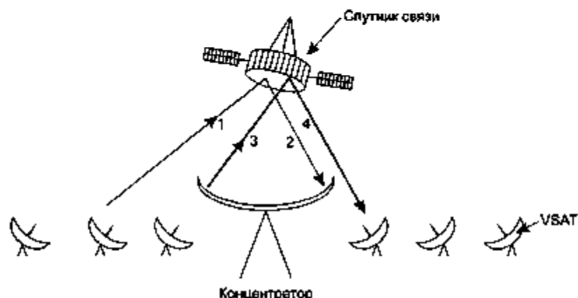
Рис. 2.14. Хаб распределяет трафик между несколькими VSAT
