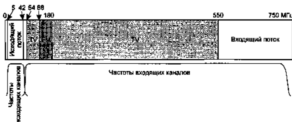
Рис. 2.42. Распределение частот в типичной системе кабельного телевидения, используемой для доступа в Интернет
