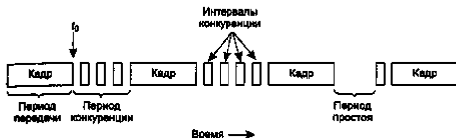
Рис. 4.5. Протокол CSMA/CD может находиться в одном из трех состояний: конкуренции, передачи и простоя
