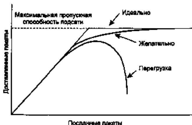
Рис. 5.23. При слишком высоком уровне трафика начинается перегрузка, и производительность сети резко снижается
