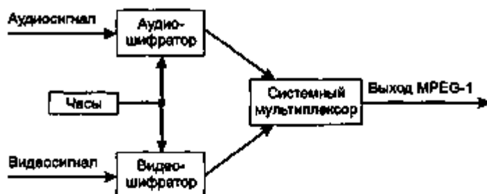
Рис. 7.42. Синхронизация аудио- и видеопотоков в MPEG-1
