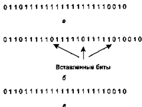
Рис. 3.6. Битовое заполнение: исходные данные (а); данные на линии (б); данные, сохраненные в памяти после удаления вставных битов (в)
