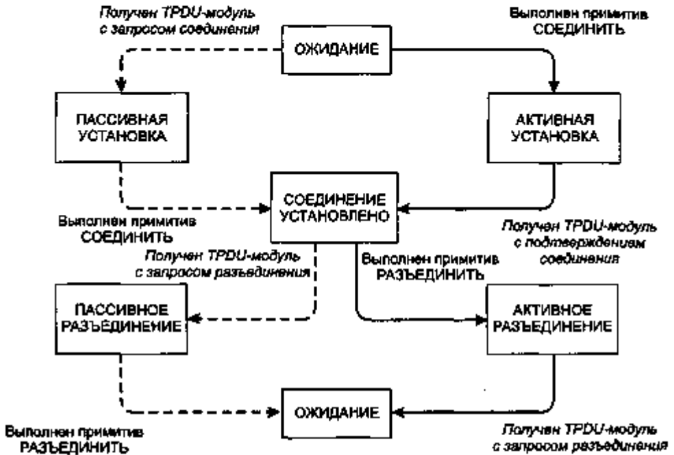
Рис. 6.3. Диаграмма состояний для простой схемы управления соединениями. Переходы, обозначенные курсивом, вызываются прибытием пакетов. Сплошными линиями показана последовательность состояний клиента. Пунктирными линиями показана последовательность состояний сервера
