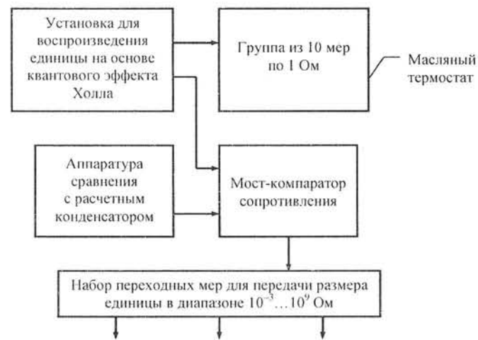
Рис. 3.18. Структурная схема ГПЭ электрического сопротивления России
