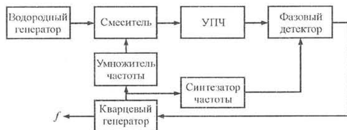
Рис. 2.5. Структурная схема водородного стандарта частоты
