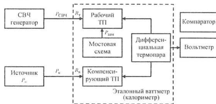
Рис. 4.24. Структурная схема эталона мощности ВЧ и СВЧ
