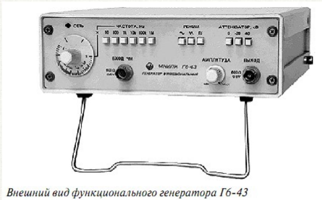
Внешний вид функционального генератора Г6-43
