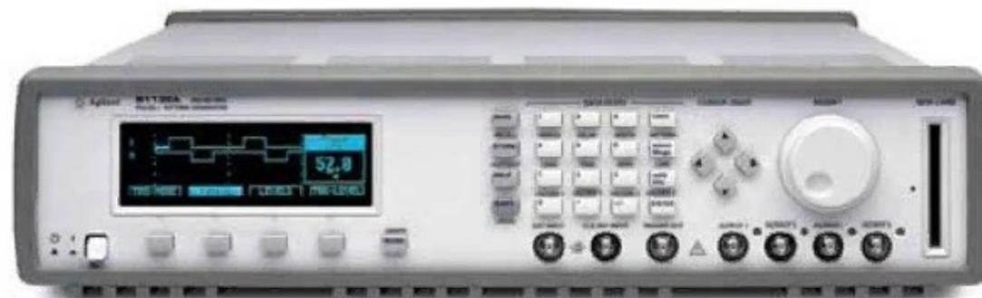
Keysight 81101A генератор импульсов
