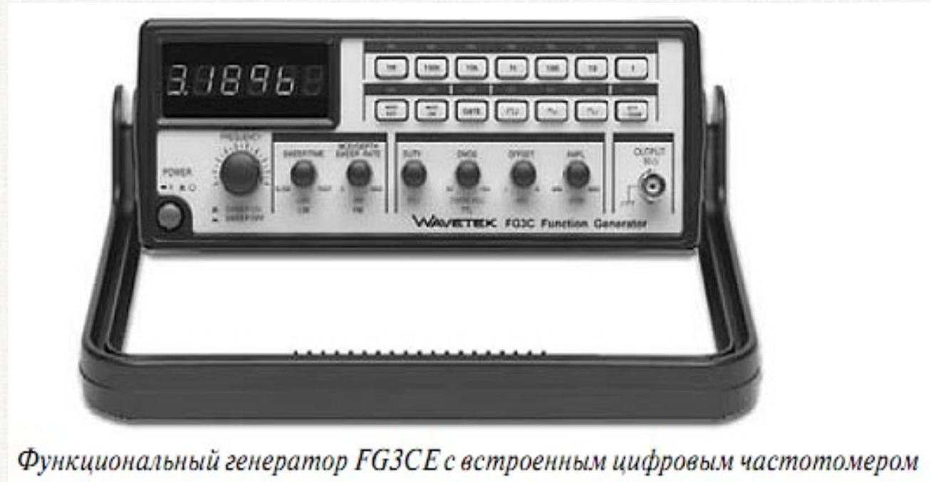
Функциональный генератор FG3CE с встроенным цифровым частотомером
