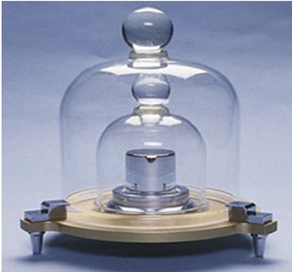
В **1889** году роль прототипа килограмма была «поручена» цилиндрической гире из платино-иридиевого сплава, а ее 40 точных копий стали международными эталонами. Две из них ( № 12 и № 26 ) были переданы России.
