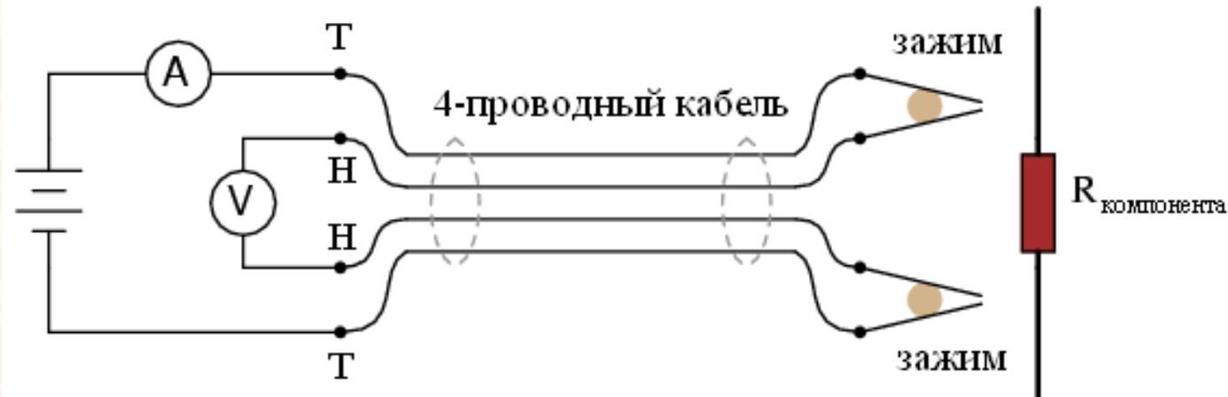
$$R_{\text{компонента}} = \frac{\text{Показания вольтметра}}{\text{Показания амперметра}}$$
