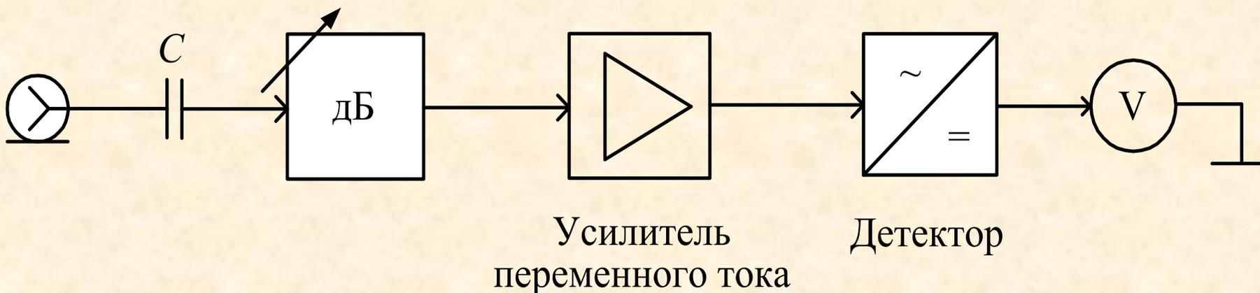
Вольтметр переменного тока типа **«усилитель-детектор»** - высокая чувствительность, большое входное сопротивление, ограниченный частотный диапазон
