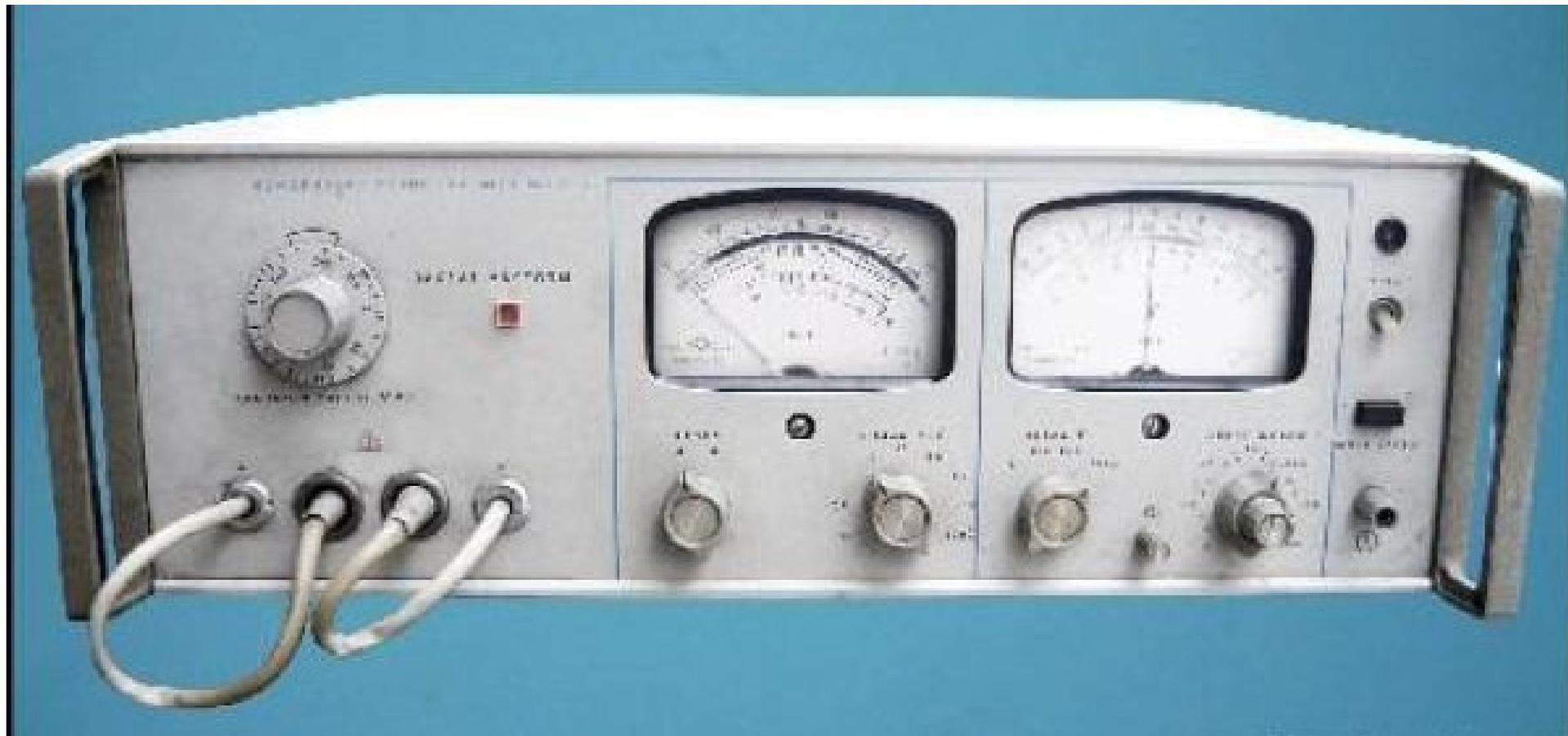
Аналоговый ВЧ фазометр для частотного диапазона 1-1000 МГц. Диапазон измерения: разности фаз  $0 \pm 180^\circ$ ; напряжения 100 мкВ-1 В. Погрешность измерения: разности фаз не более  $\pm 2,5^\circ$ ; напряжения 10% (1-300 МГц), 20% (300-500 МГц)
