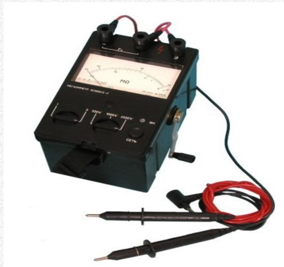
Мегаомметр для измерения сопротивления изоляции электрических цепей
