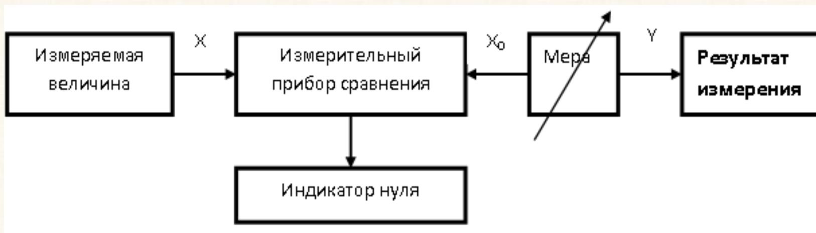
**Дифференциальный метод** - метод уравнивания, в котором разность определяемой величины и меры не доводится до нуля, а устанавливается заранее заданному значению и фиксируется измерительным прибором.
