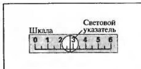
Рис. 1.23. Оптический отсчет
