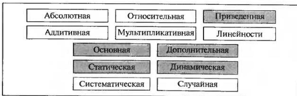
Рис. 1.9. Упрощенная классификация погрешностей средств измерений
