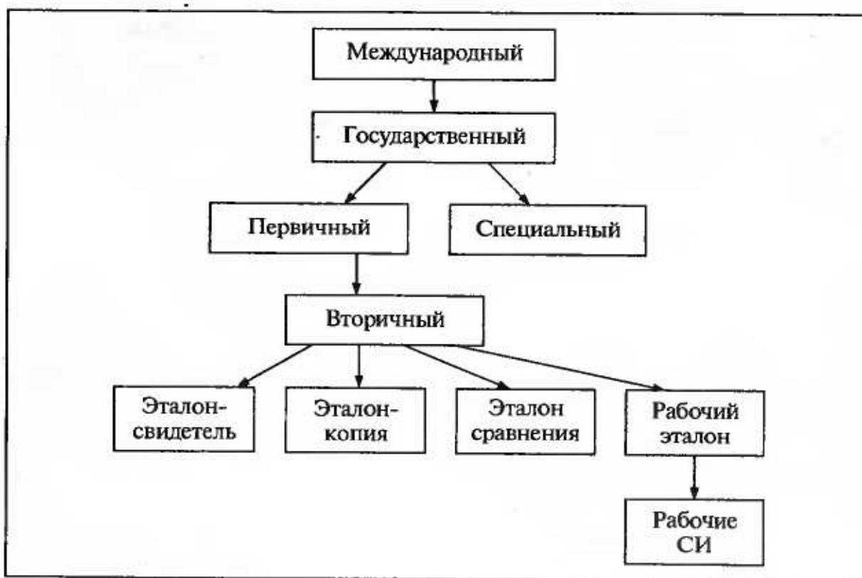
Рис. 1.6. Схема передачи размера единицы
