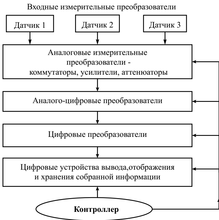
Рис. 16.2. Структурная схема информационно-измерительной системы
