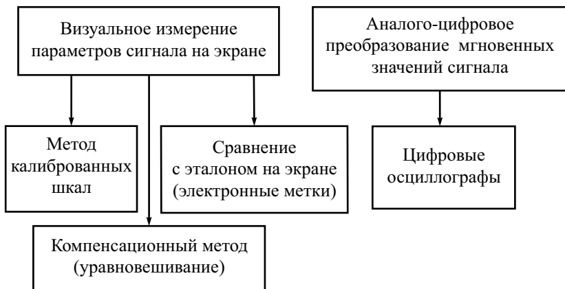
Рис. 4.12. Классификация осциллографических методов измерения напряжения
