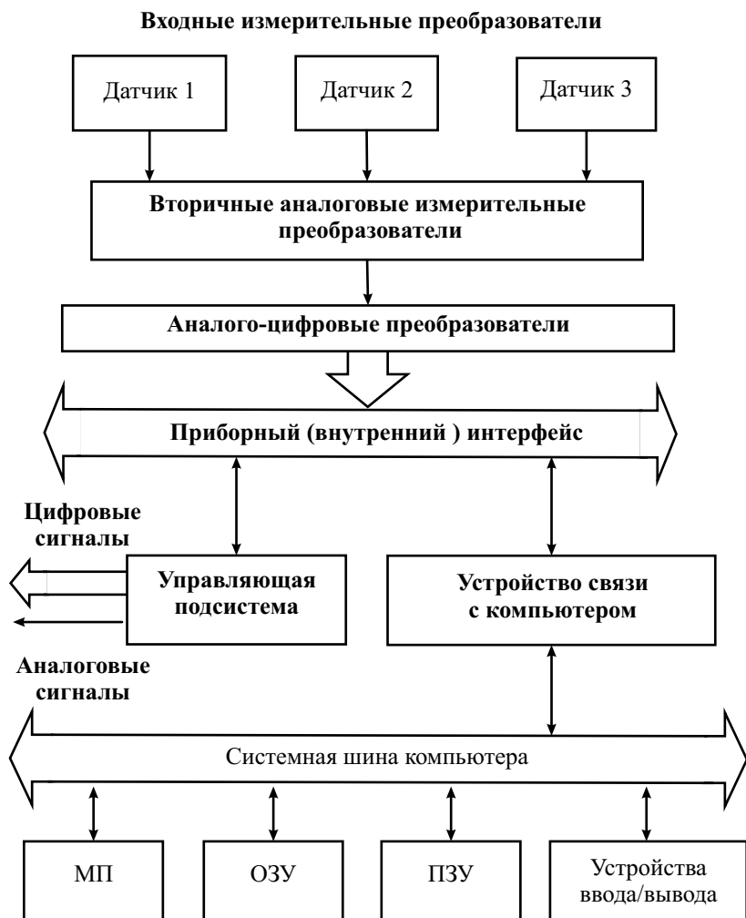
Рис. 16.3. Структурная схема измерительно-вычислительного комплекса
