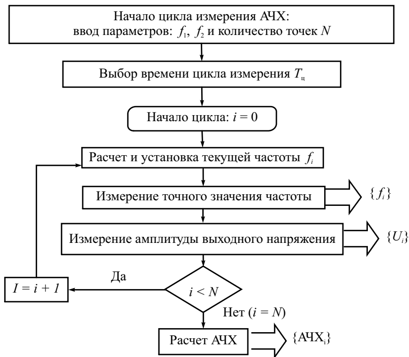
Рис. 14.16. Алгоритм работы микропроцессорного измерителя АЧХ
