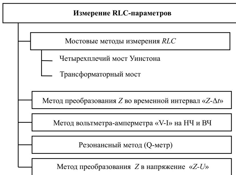
Рис. 13.6. Классификация методов измерения параметров двухполюсников
