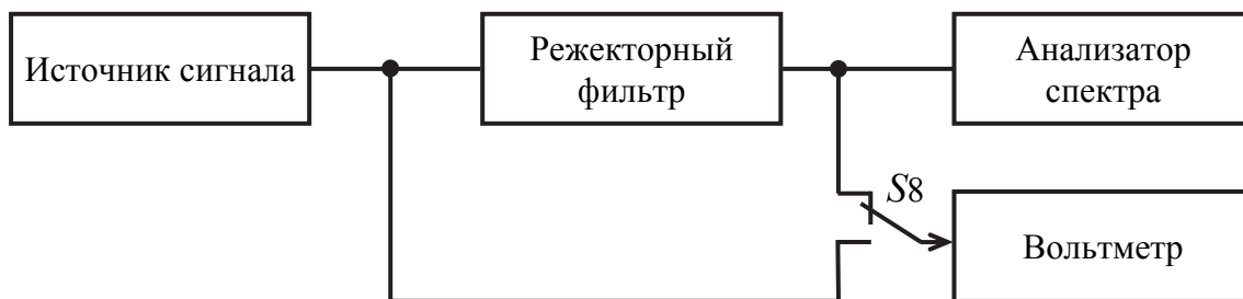
Рис. 12.4. Структурная схема для определения коэффициентов гармоник менее 0,5 %
