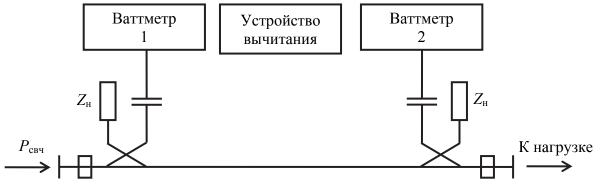
Рис. 14.12. Схема измерения проходящей мощности с двумя направленными ответвителями
