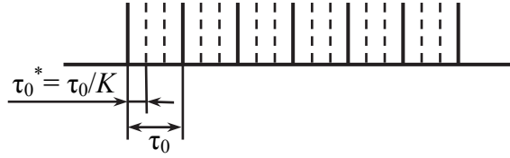
Рис. 5.7. Последовательность квантовых импульсов, полученная наложением K временных интервалов
