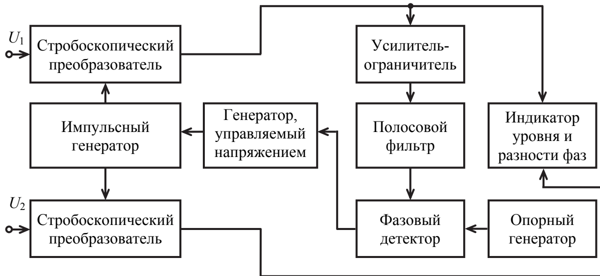
Рис. 7.14. Структурная схема измерителя фазы со стробоскопическим преобразователем частоты
