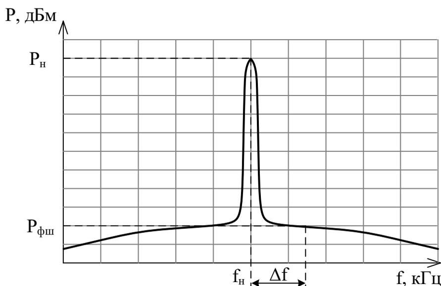
Рис. 4.7. Спектрограмма фазового шума выходного сигнала усилителя
