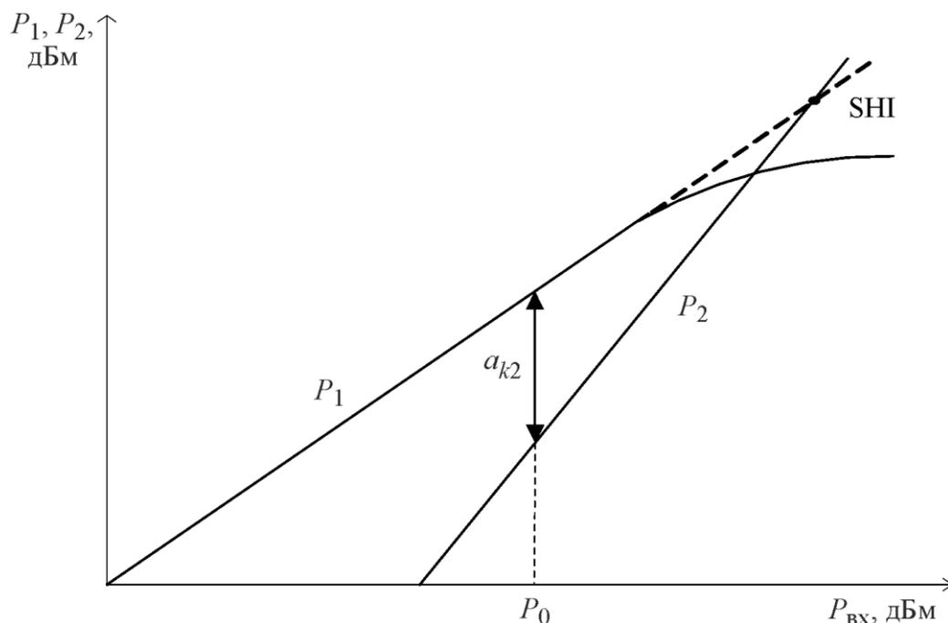
Рис. 4.6. Определение точки пересечения со второй гармоникой
