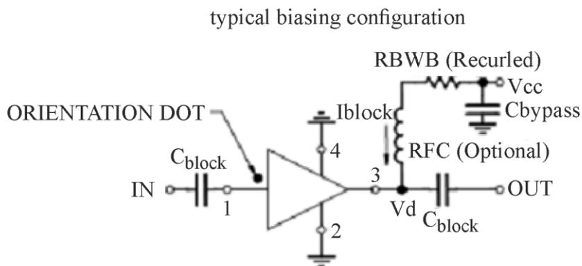
Рис. 4.5. Схема интегрального СВЧ-усилителя
