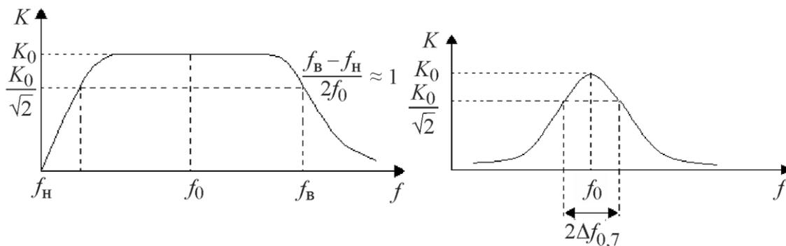
Рис. 4.1. АЧХ СВЧ-усилителей: *a* – широкополосный; *b* – узкополосный
