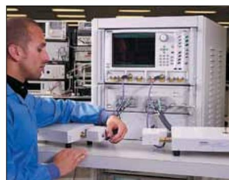
Рис. 7. Рабочее место с четырехпортовой измерительной системой
