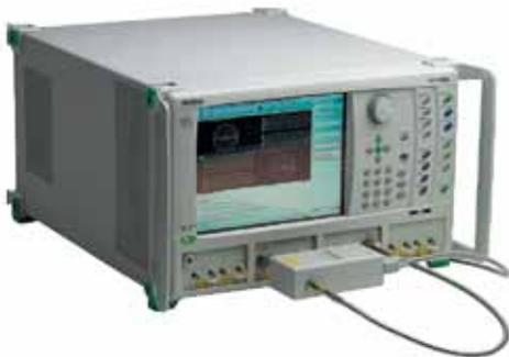
Рис. 12. Подключение блока калибровки к анализатору цепей
