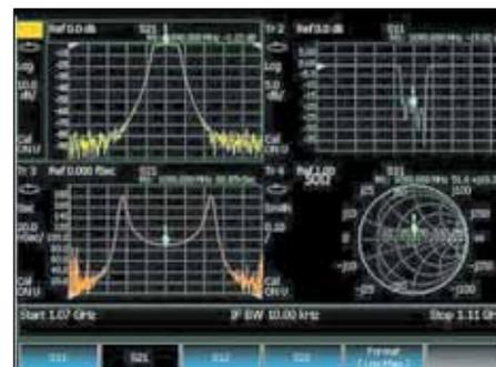
Рис. 19. Экран с результатами измерения S-параметров
