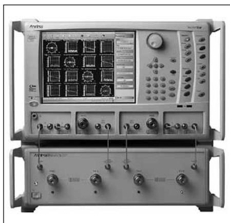
Рис. 5. Преобразование двухпортового анализатора цепей в четырехпортовую измерительную систему анализа цепей
