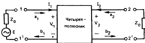
Рис. 1.1. Схема, иллюстрирующая определение входной и выходной волн четырехполюсника
