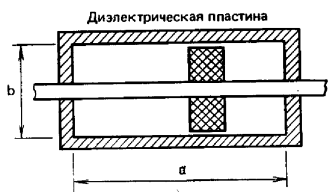
Рис. 5.1. Поперечное сечение волноводного фазовращателя с диэлектрической пластиной
