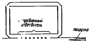
Рис. 14.01.4. Волноводный умножитель мощности на кольцевом резонаторе бегущей волны
