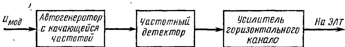
Рис. 14.7. Линеаризация модуляционной характеристики ГКЧ с помощью частотного детектора
