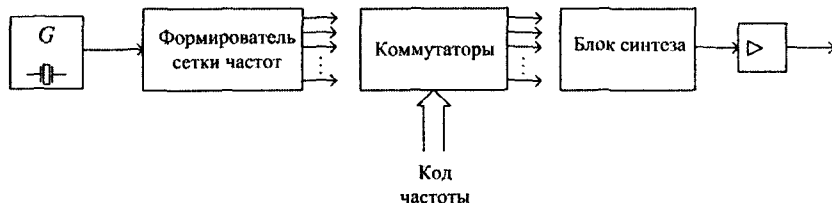
Рис. 6.5. Схема генератора с прямым синтезом частот
