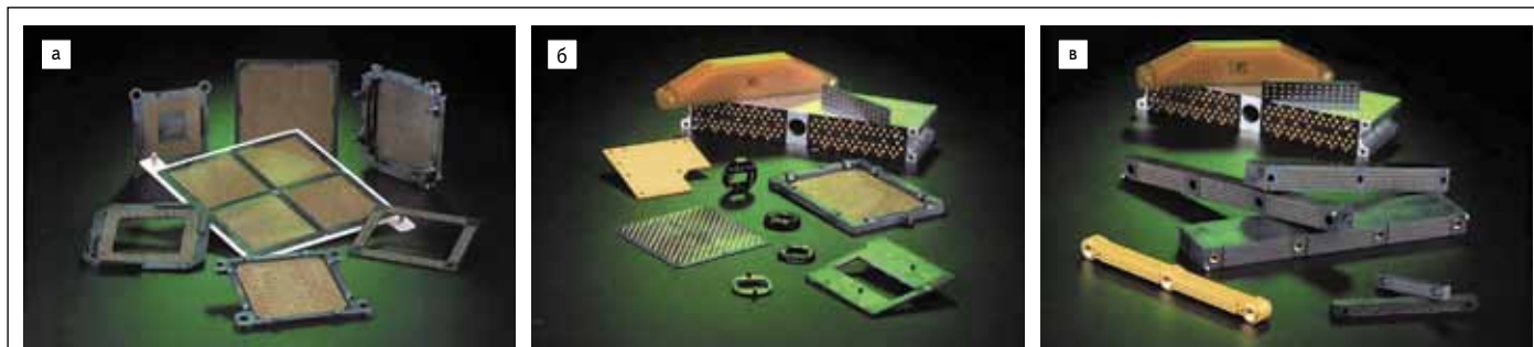
Рис. 9. Многовыводные платы с контактами CIN::APSE: а) для компьютеров; б) систем телекоммуникации; в) военного назначения
