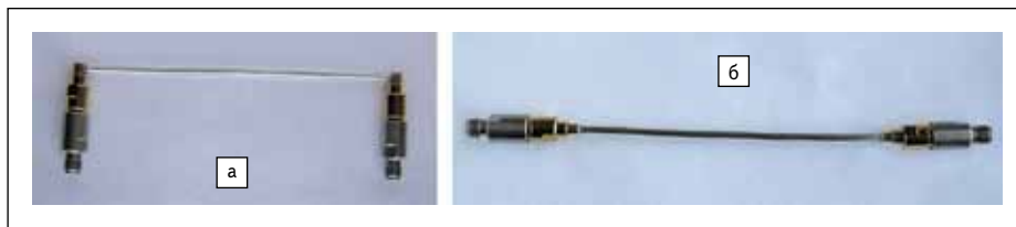
Рис. 6. Кабельные сборки: а) с угловыми соединителями и адаптерами; б) с прямыми соединителями и адаптерами
