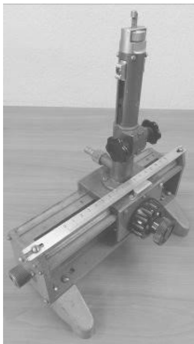
Рис. 5.8. Внешний вид коаксиальной измерительной линии Р1-3 для диапазона частот 2.5...10.35 ГГц
