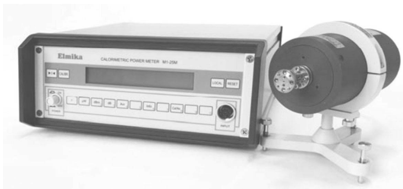
Рис. 11.18. Волноводный ваттметр КВЧ-диапазона частот
