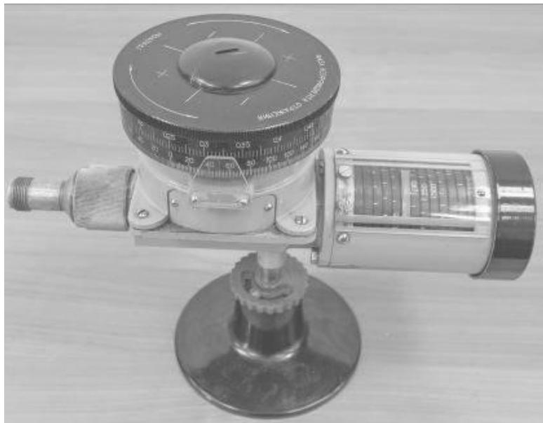
Рис. 5.14. Внешний вид коаксиального поляризационного измерителя полных сопротивлений
