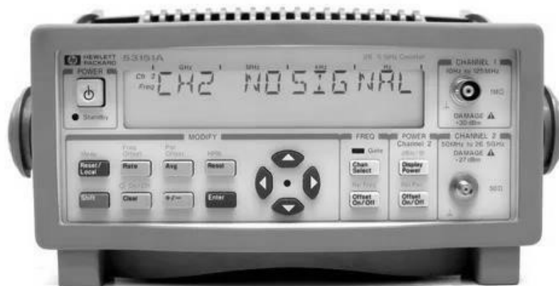
Рис. 12.12. Частотомер Keysight 53151A с блоком СВЧ преобразователя частоты
