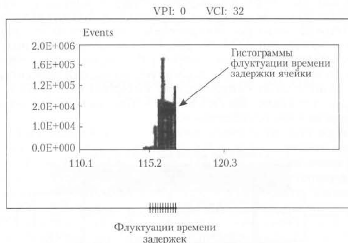
Рис 11.13. Пример измерения времени задержки
