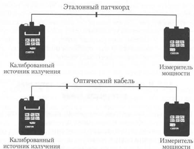
Рис. 12.2. Схема определения затухания волокна методом вносимых потерь
