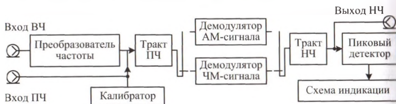
Рис. 7.3. Структурная схема модулометра
