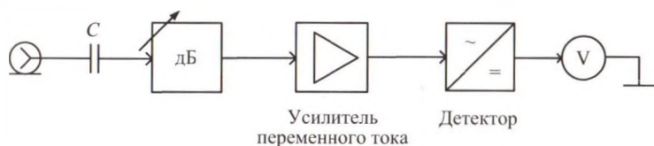
Рис. 1.10. Структурная схема вольтметра переменного тока
