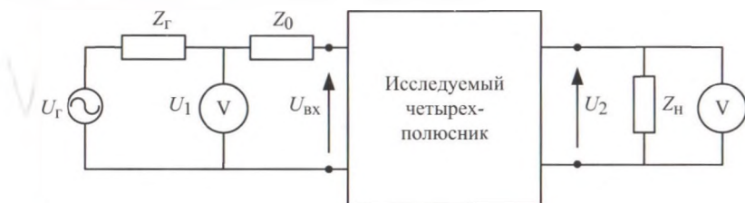
Рис. 10.5. Измерение АЧХ четырехполосника по точкам с помощью двух вольтметров
