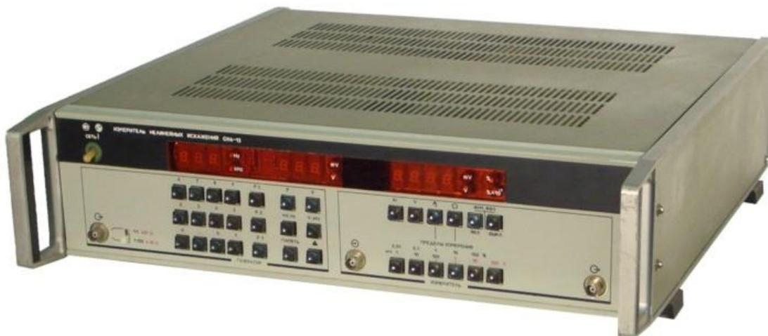
Автоматизированный цифровой прибор СК6-13 предназначен для измерения коэффициента гармоник и среднеквадратического значения напряжения. Он состоит из измерителя нелинейных искажений и перестраиваемого синхронно с ним генератора гармонического сигнала. Прибор СК6-13 обеспечивает автоматическое и ручное переключение пределов измерения, возможность запоминания значений частоты и напряжения генератора, вывод результата измерения на печать.
