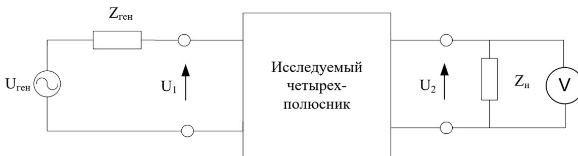
Рис. 3.1. Общая схема включения четырехполюсника для измерения АЧХ
